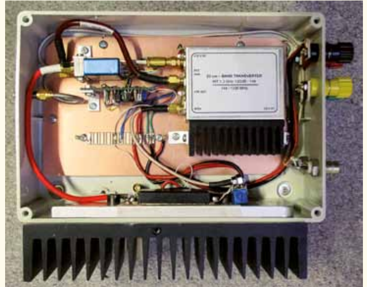
Ingebouwd in een Schyller 93244 montagekast met afmetingen van 150 × 220 × 75 mm
