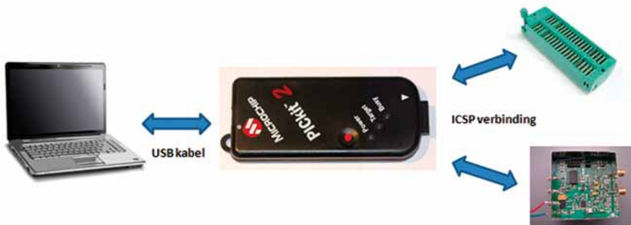
Afbeelding 1 Overzichtplaatje. Op de computer staat de PICkit software, en aan de ICSP-connector wordt de te programmeren PIC aangesloten.
