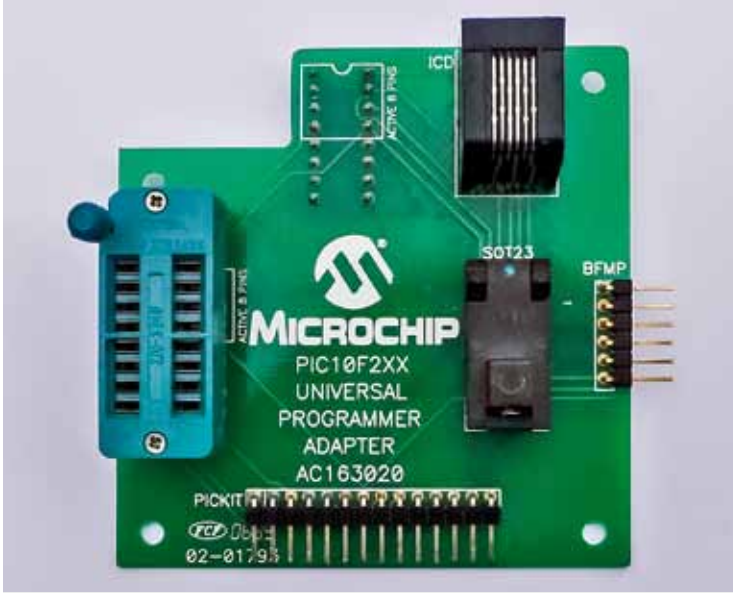
Een originele Microchip adapter voor het programmeren van de in-line en SMD-versie van de 10F20x-serie. Deze adapter past direct op de PICkit 2.
