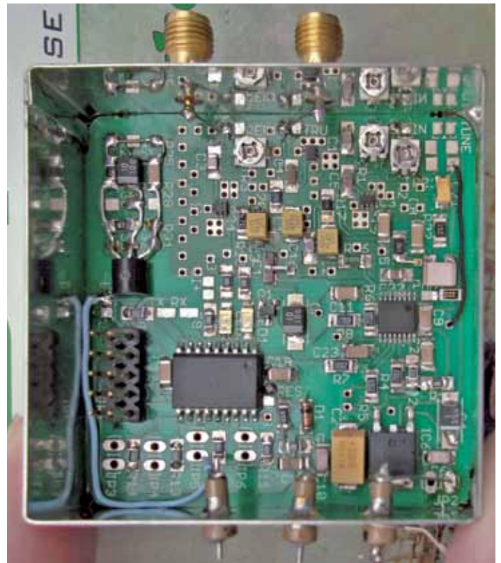
Foto 3 Een PLL-schakeling met een LMX2306 bestuurd door een PIC 16F628A
