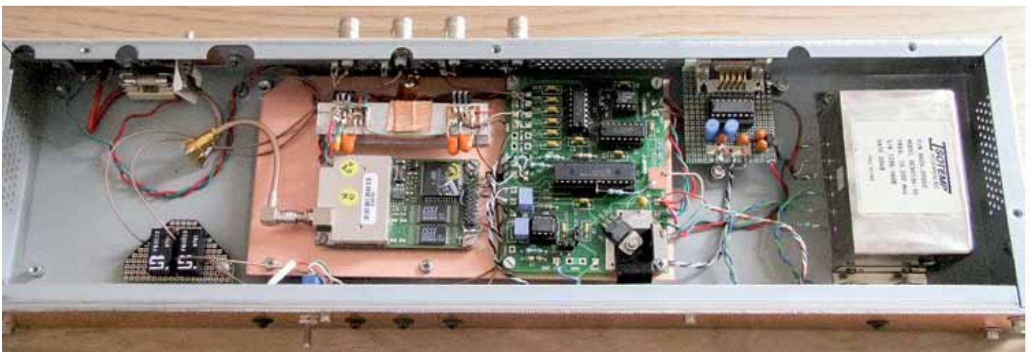
Foto 2 Door de auteur gebouwde gps-gestuurde 10 MHz-standaard van VE2ZAZ met PIC 18F2220
