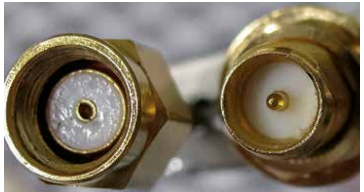
Rechts het 'verkeerd om' male SMA-contact; links een gemodificeerde SMA-connector die nu daarop past
