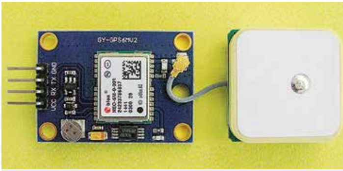
Een GY-NEO6MV2 module met patchantenne
