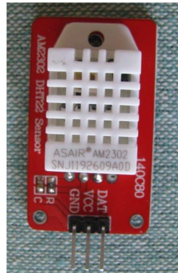
De DHT22 sensor op een printje gemonteerd
