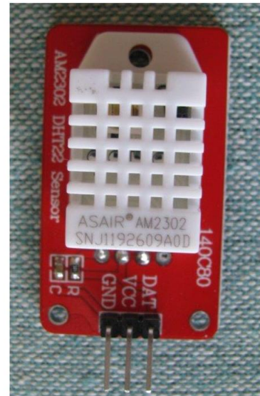
De DHT22 sensor op een printje gemonteerd
